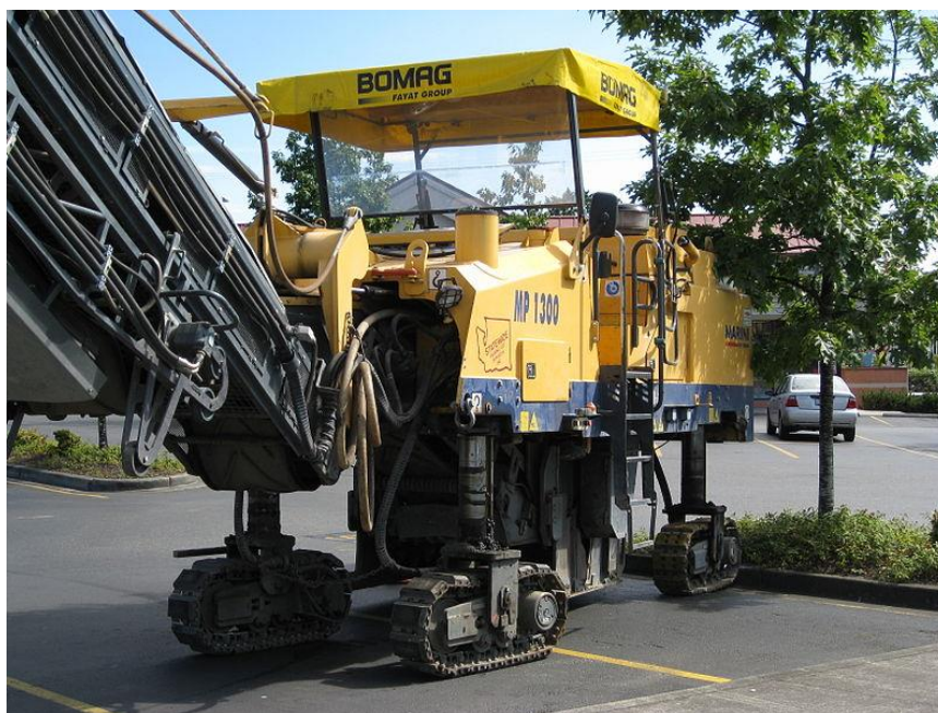
2- сурет – жол фрезасы BOMAG MP 1300.
